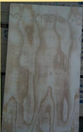
*\*C+C: 1 Cara semi lijada con nudos resanados, acabado semi aparente 15mm y 18mm.*
